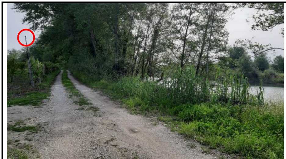
Εικόνα 3-3 Το μικρόφωνο σε στύλο 3m (στον φράχτη, αριστερά του δρόμου) που συνδέεται με το καταγραφικό SM4BAT-FS στην περιοχή του Αράχθου.
