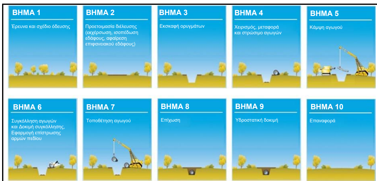
Εικόνα 4-2 Τυπική ακολουθία κατασκευής αγωγών
