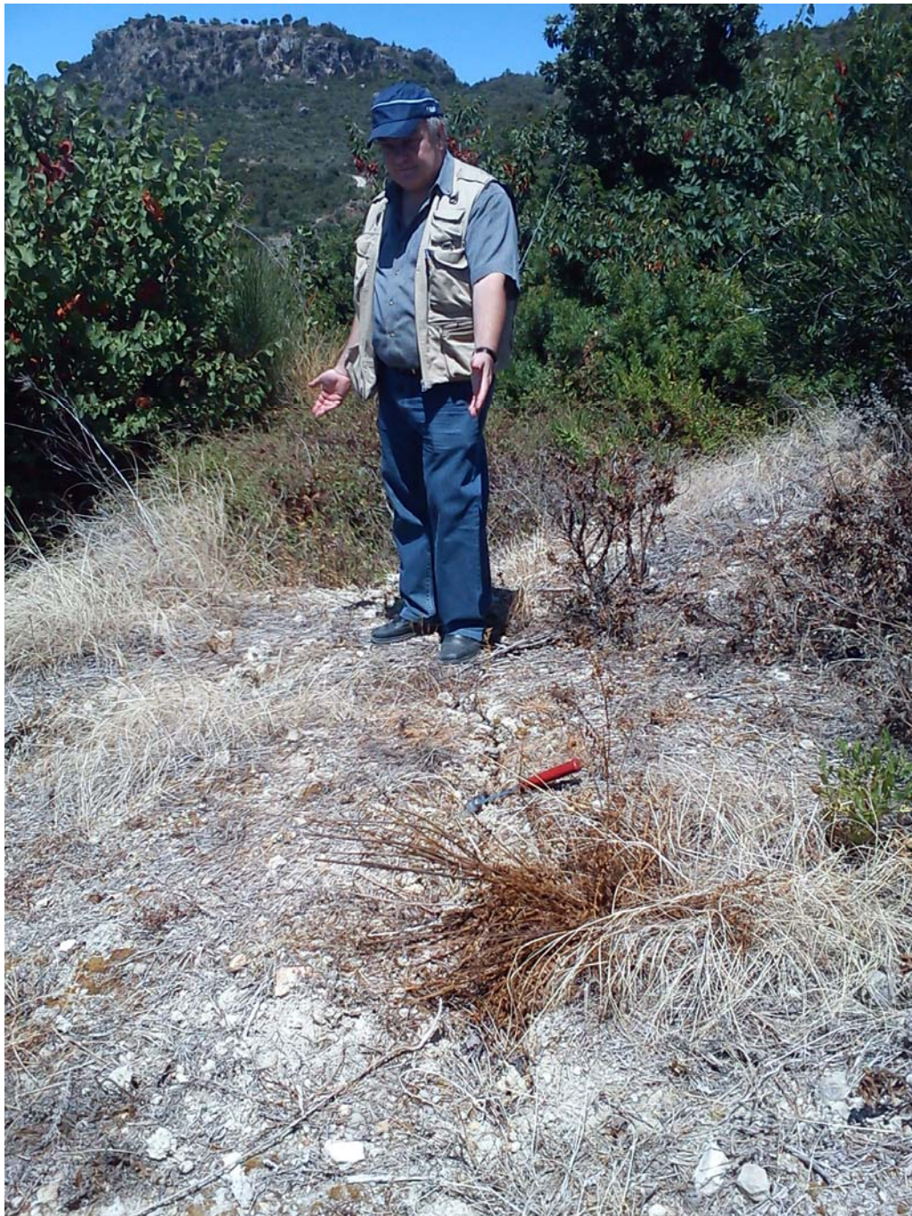
Photo 4: Field view of a crack formed in the marl sediments due to surficial creep in the section A as shown by Spyros Pavlides (site x/y:180.604/4.358.642, Greek Grid). Εικόνα 4: Άποψη της θραύσης που παρατηρείται στα μαργαίκα ιζήματα λόγω της δράσης επιφανειακού ερπυσμού στην τομή Α, όπως δείχνει ο Σπύρος Παυλίδης (σημείο χ/γ:180.604/4.358.64 ΕΓΣΑ87).
