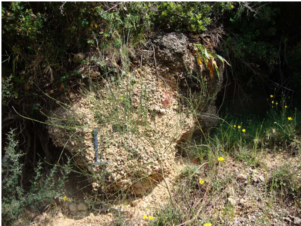
Photo 7: Detail view of the map unit sc1 (L) that covers the map unit (Pl.m) on the western slopes of the mountain chain of the pipeline section A (site x/y:180.882/4.358.735, Greek Grid). Εικόνα 7: Λεπτομερής άποψη των κορημάτων που καλύπτουν τα μαργαϊκά ιζήματα.
